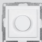
Светорегулятор с поворотной ручкой типа WS 064, 60 - 320 W для ламп накаливания, 230 V~, 50 Hz, галогеновых ламп низкого напряжения с электронным трансформатором, с элементом памяти, включение/выключение нажатием рукоятки (функция softstart/softstop), электронная защита от помех, предохранитель T2AH
