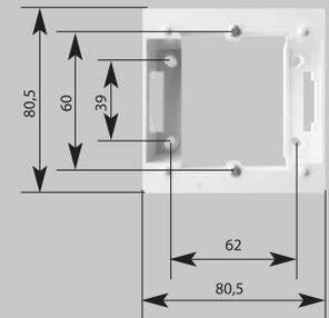
Адаптер для наружного монтажа серии Fiorena, основной модуль
