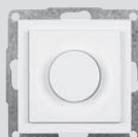
Светорегулятор сенсорный типа WS 066, 60 - 400 W для ламп накаливания, 230 V~, 50 Hz, галогеновых ламп низкого напряжения с ферромагнитным трансформатором, с элементом памяти, длительное нажатие рукоятки регулирует яркость освещения, включение/выключение коротким нажатием рукоятки (функция softstart/softstop), электронная защита от помех, предохранитель T2AH
