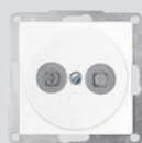
Предназначена для медицинских учреждений, «заземляет» переносную медицинскую аппаратуру. Крепится к коробке Ø 60 мм, возможно подключение проводов 1 x 6 мм<sup>2</sup> + 4 x 2,5 мм<sup>2</sup>, диаметр отверстий Ø 14,3, диаметр болтов Ø 5,95, с винтовыми клеммами
