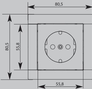
Розетка с заземлением типа schuko
