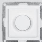
Светорегулятор с поворотной ручкой типа WS 063, 60 - 400 W для ламп накаливания, 230 V~, 50 Hz, галогеновых ламп низкого напряжения с ферромагнитным трансформатором, с элементом памяти, включение/выключение нажатием рукоятки (функция softstart/softstop), возможность управления внешней кнопкой, электронная защита от помех, предохранитель T2AH
