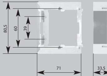
Адаптер для наружного монтажа серии Fiorena, дополнительный модуль
