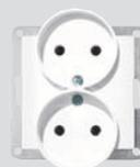
Розетка двойная без заземления, 16 А, 250 V~, с винтовыми клеммами, для однократных или многократных рамок
