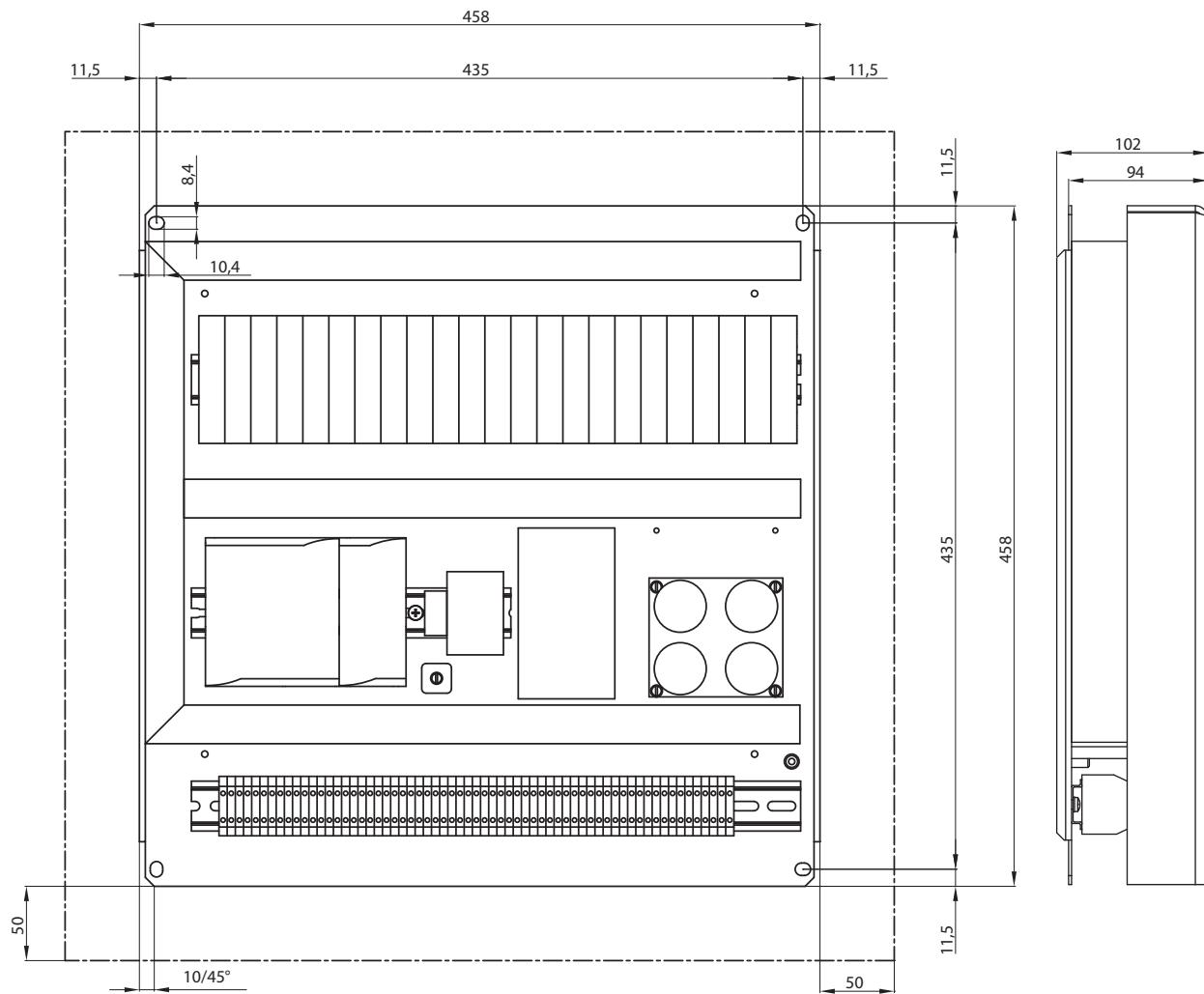
План сверления для установки пластмассовой крышки
