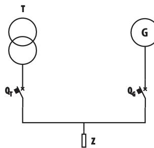
**Режим:** определяет приоритет источников в автоматическом режиме (настраивается на контактном дисплее автомата)
