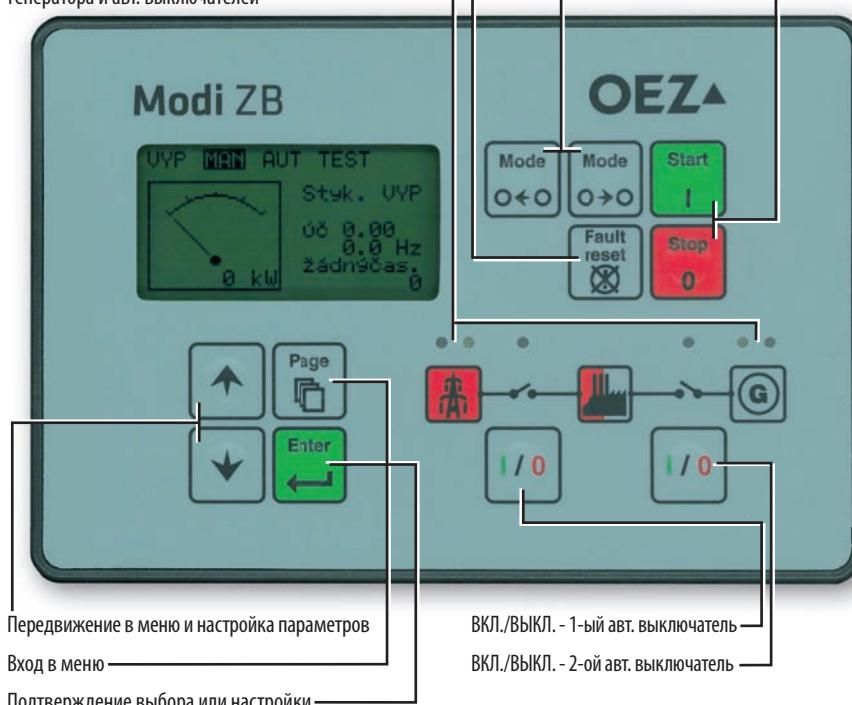
подключить (включить авт. выключатель) только вручную, нажатием соответствующей кнопки «I/O» на устройстве управления.
